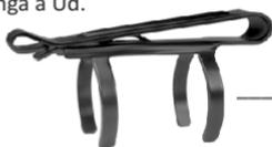
Para quitar el clip imponga en la anchura del clip un palillo de dimensiones correspondientes (un destornillador, por ejemplo) y tire equitativamente sus extremos, según el dibujo.
